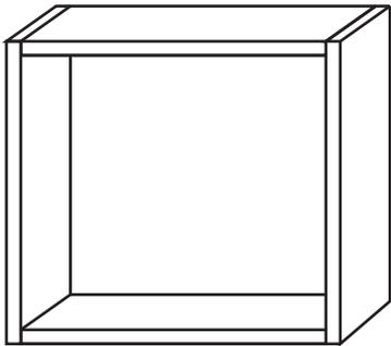
6 縦板と横板の接地面にクギを各3カ所ずつと、裏側に図のようにクギをうちつけてベニヤ板を取り付けます。
