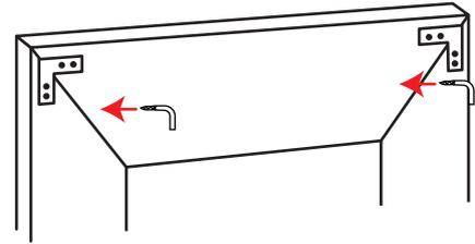
5 次に、裏側に取り付けるボックスを作ります。UROCO板を404mmと330mmに2枚ずつカットし、横板に330mmのウロコ板を縦板にしてボンドで固めて枠を作ります。
