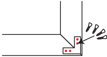
2 木工用ボンドで、カットした480mmと380mmの板の断面同士をくっつけて図の様に枠を作ります。
