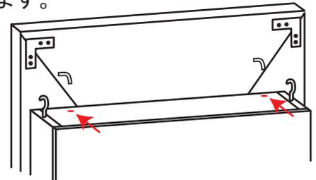
9 丸型フックに紐を取り付けて、フレームとボックスをドッキングさせてボックスに植物を入れて完成です。
