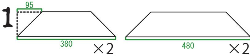
まずは、フレームを作ります。UROCO板を480mmと380mmにカットしたものを2枚ずつ用意し、端から95mmのところをナナメにカットします。
