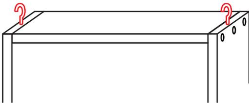
8 フレームに取り付けたL字フックの位置に合わせて、ボックス側に4mmのドリルで穴をあけます。
